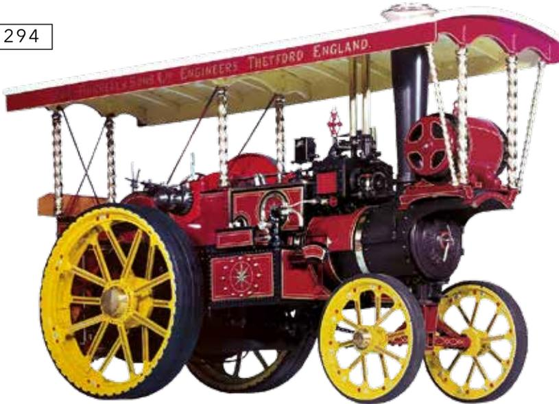
**294** Extrem detailliertes Model einer Burrell 5 n.p.h. "Showman's engine" nach Bauplänen von P.Penn-Sayers, Laughton. Dampfbetrieben in top Zustand. Dampfkessel nicht geprüft. Masse: 51cm hoch, 77,5cm breit. **An extremely fine exhibition standart 2in. scale model of a Burrell 5 n.p.h.** double crank compund three shaft two speed Showman's Road Locomotive built from works drawing by P. Penn-Sayers, Laughton. Size: 20in. x 30½in.
